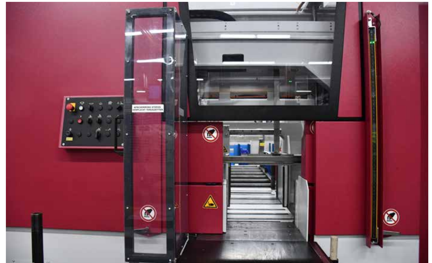
De machine werd tevens verbonden met de afvoertafel als extra beveiliging. Je kan het plexischerm dat rond de toegang staat nu niet zomaar wegnemen.
